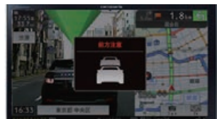
前方車両に接近しすぎると警告音とともに「前方注意」の表示。ドライバーの安全運転をサポート
